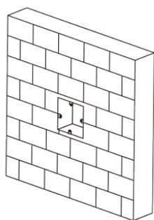
**Paso 1:** Instalar caja estanca. Utilice los 4 tornillos suministrados para fijar la placa de montaje en la caja eléctrica.
