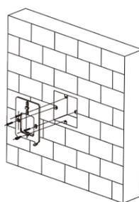
**Paso 2:** Instalar la placa de montaje. Pase los cables a través del orificio para cables de la placa y conéctelos correctamente a los periféricos.
