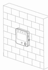
**Paso 3:** Utilice el tornillo suministrado para fijar el dispositivo en la placa.
