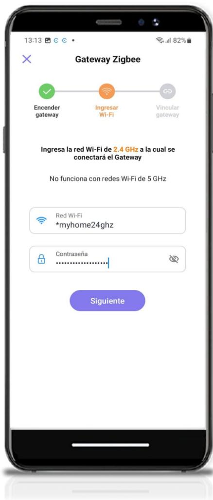
**Paso 2 . Ingresar la contraseña de tu red Wi-Fi de 2.4 GHz (el gateway no es compatible con redes de 5 GHz). Toca "Siguiente" para continuar.**
